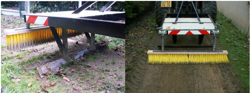
Matériel réalisé par la commune de Cintré
